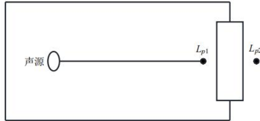
图 4-3 室内声源等效为室外声源图例
