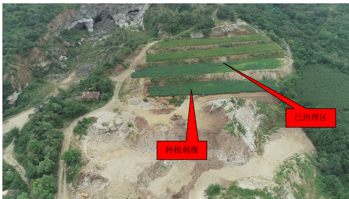
图 2-10 祥和矿业有限公司（硅灰石矿）露天采场平台已治理区
